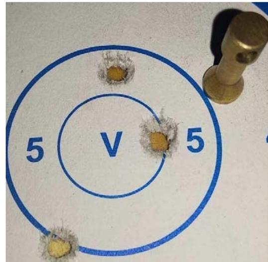
Es evidente a simple vista que, **SIN EL USO DEL CALIBRADOR**, en la fotografía de la izquierda vemos que el agujero en el 4, no toca la línea del 5. En cambio, en la fotografía de la derecha, **AL PONER EL CALIBRADOR** vemos que es plenamente tangente a la línea de mayor puntuación. Por lo tanto la puntuación del disparo es un cinco (5).
