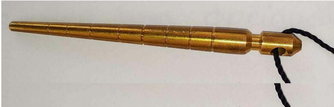
Hay que tener mucho cuidado al introducir el calibrador de profundidad. Deberán usarse calibradores de un peso que esté de acorde con el gramaje del cartón del blanco. Si se utilizan calibradores demasiado pesados, la lectura puede ser errónea ya que al introducirlos ensancharan el agujero, alterando la naturaleza del cartón del blanco. El calibrador de la foto de arriba esta construido de latón, material ligeramente superior a los calibradores de aluminio.
